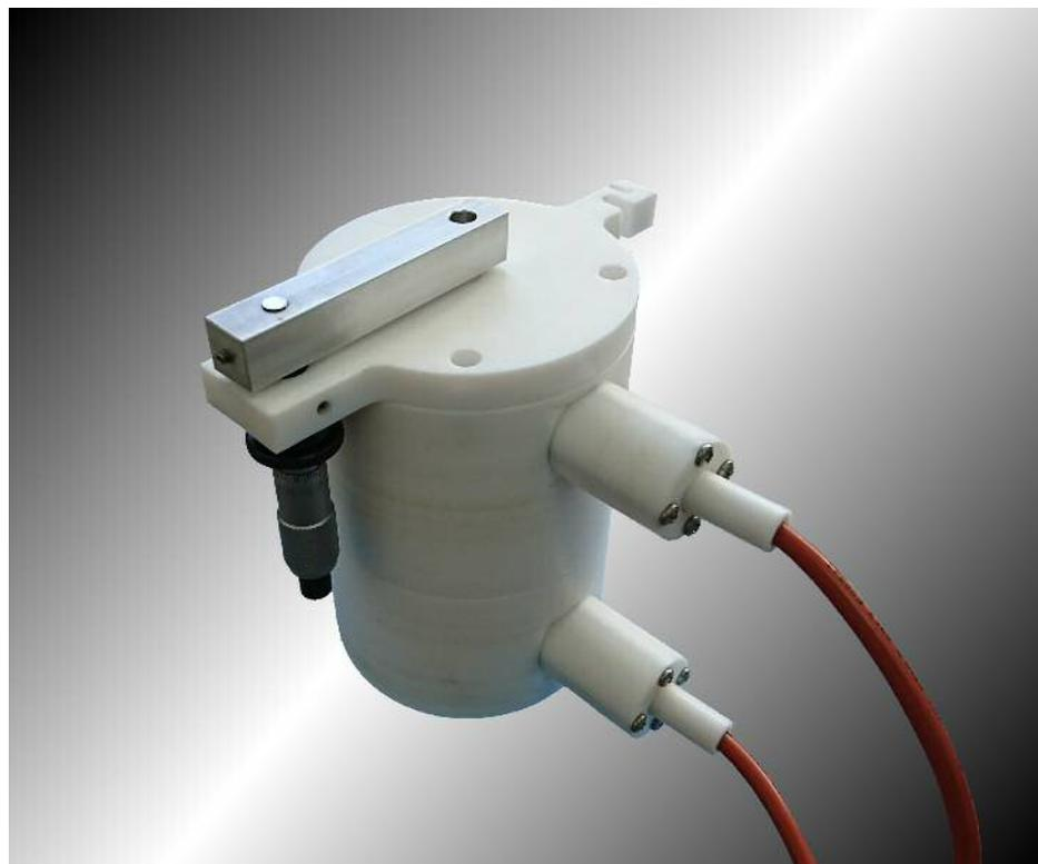
変位計対応型高電圧試料治具(HVDM)
